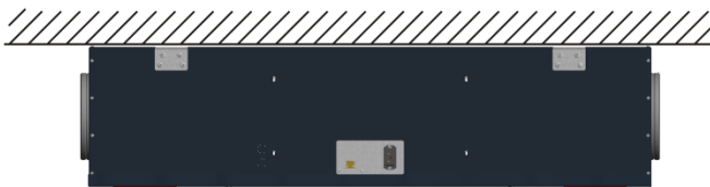
Fig. 16 : position de montage suspendue au plafond
