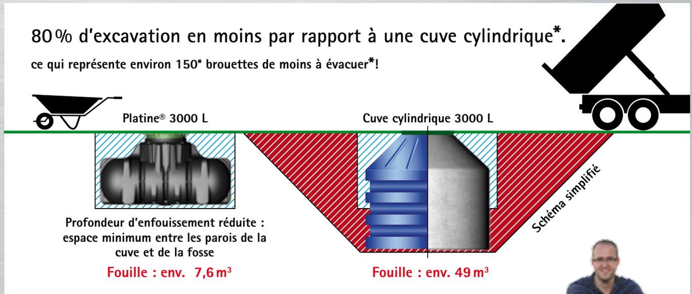
"La cuve à enterrer Platine® s'installe facilement et rapidement.
